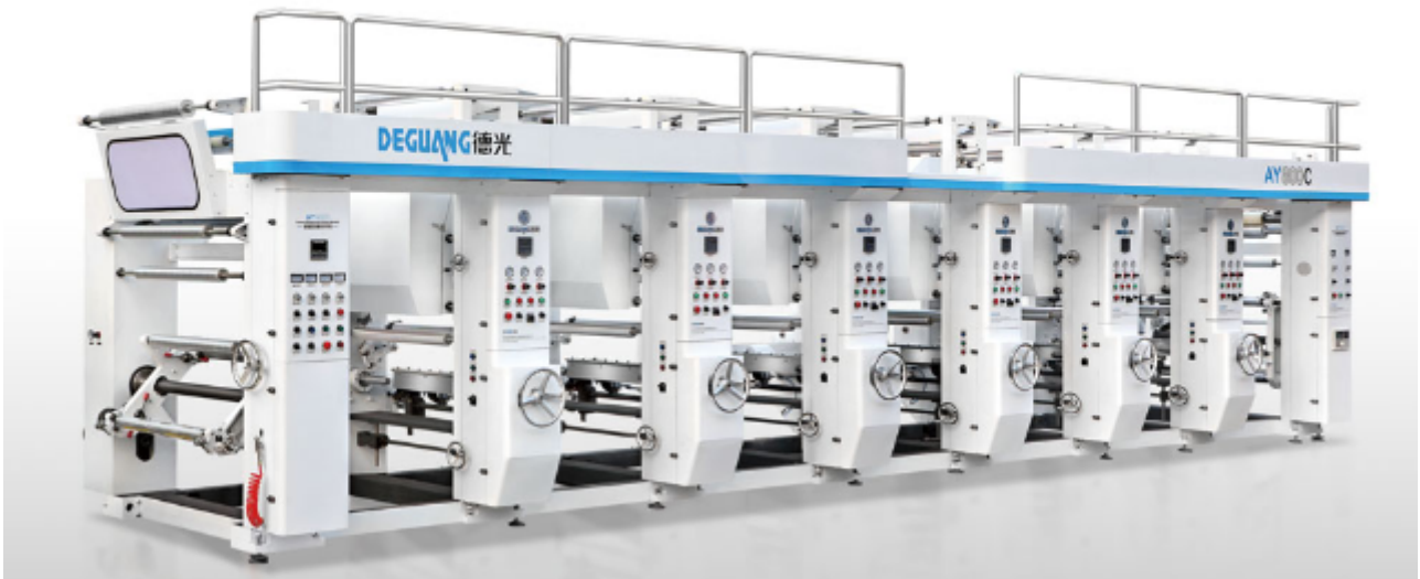
AY800C 普通凹版彩印机 General Rotogravure Printing Machine
